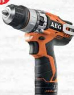
Batteria al Litio da 12Volt/2,0 Ah. Mandrino FIXTEC autoserrante in metallo da 10 mm, 2 velocità: 0-400/0-1500 g/min., coppia max 32 Nm. Interruttore elettronico con velocità variabile. Selettori a 3 modalità: avvitatura, foratura e foratura con percussione. Colpi: 22500/min. Campo di foratura: Ø foro legno 20 mm, Ø foro acciaio 10 mm, Ø foro muratura 10 mm. Illuminazione a LED dell'area di lavoro. In dotazione: 2 batterie, caricabatteria, valigia.
