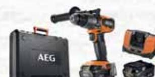
Trapano a percussione ultra compatto. Batteria al Litio da 18Volt/4,0 Ah con indicatore dello stato di carica. Mandrino 13 mm completamente in metallo, 2 velocità: 0-500/0-2100 g/min., coppia max 110 Nm. 24 regolazioni di frizione per il massimo controllo. Colpi 31500/min. Campo di foratura: Ø foro legno 65 mm, Ø foro acciaio 13 mm, Ø foro muratura 13. Illuminazione a LED dell'area di lavoro. In dotazione: 2 batterie, caricabatteria, valigia.
