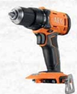
Trapano a percussione ultra compatto. Batteria al Litio da 18Volt/2,0 Ah con indicatore dello stato di carica. Mandrino autoserrante da 13 mm, 2 velocità: 0-500/0-1800 g/min., coppia max 60 Nm, frequenza di percussione (colpi/min) 28'000. Campo di foratura: Ø foro legno 54 mm, Ø foro acciaio 13 mm, Ø foro muratura 13. In dotazione: 2 batterie da 2,0Ah, caricabatteria, valigia.
