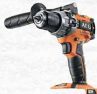
Trapano a percussione ultra compatto. Motore 4 poli frameless. Mandrino FIXTEC autoserrante in metallo da 13 mm, 2 velocità: 0-450/0-1650 g/min., coppia max 70 Nm. 24 regolazioni di frizione per il massimo controllo. Campo di foratura: Ø foro legno 45 mm, Ø foro acciaio 13 mm, Ø foro muratura 14. Illuminazione a LED dell'area di lavoro. Batteria e caricabatteria non inclusi. Compatibilità batteria 18V.
