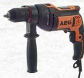
Mandrino autoserrante in metallo da 13 mm, reversibile, collare da 43 mm, utilizzabile su supporti per trapani, velocità variabile tramite rotella, con possibilità di blocco in funzione dell'interruttore, impugnatura Softgrip. Campo di foratura: Ø foro legno 30 mm, Ø foro acciaio 13 mm, Ø foro calcestruzzo 16 mm, Ø foro muratura 20 mm, coppia max 27 Nm, 0-3000 g/min., 23200 colpi/min., In dotazione: impugnatura supplementare, asta di profondità e valigetta.
