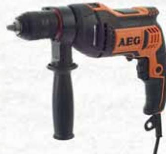
Motore da 750 watt di potenza. Capacità di foratura: Legno 30 mm, Metallo 13mm. Coppia 27 NM. Velocità variabile tramite rotella, con possibilità di blocco in funzione dell'interruttore. Fino a 3.000 g/min. Integrated Metal Block (IMB) per una maggiore durata e stabilità durante l'applicazione. Mandrino autoserrante in metallo da 13 mm. Impugnatura Softgrip per una presa perfetta e una comoda maneggevolezza.
