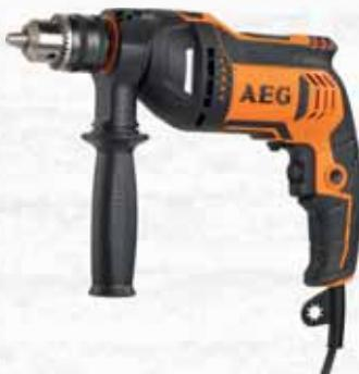
Mandrino a cremagliera da 13 mm, reversibile, collare da 43 mm, utilizzabile su supporti per trapani, velocità variabile tramite rotella, con possibilità di blocco in funzione dell'interruttore, impugnatura Softgrip. Campo di foratura: Ø foro legno 30 mm, Ø foro acciaio 13 mm, Ø foro calcestruzzo 16 mm, Ø foro muratura 20 mm, coppia max 27 Nm, 0-3000 g/min., 23200 colpi/min., In dotazione: impugnatura supplementare, asta di profondità e valigetta.
