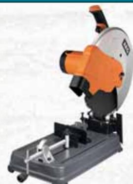
Diametro disco mm.355, inclinazione di taglio 0-45° con facile rilascio del morsetto da taglio, blocco dell'albero per una rapida sostituzione della lama e degli accessori. Capacità di taglio: tondo a 90° mm.115, rettangolare a 90° mm.110x120, a 45° mm.95x120, quadrato a 90° mm.125x125, a 45° mm.95x95. Velocità a vuoto 3800 giri/min. In dotazione: lama e chiave.
