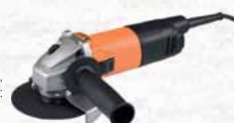
Ø disco 115 mm, n° 12000 giri/min., funzione Line lock out (LLO) per prevenire il riavvio automatico in caso di interruzione della corrente, testa degli ingranaggi ruotabile ad intervalli di 90° per una maggiore versatilità, blocco dell'alberino. Filettatura albero M14. In dotazione: impugnatura addizionale, flangia, dado per flangia e carter.
