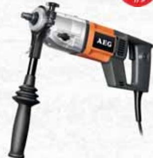
Potente motore da 1500 watt. Filettatura albero M18x2,5. Foratura diamantata a secco doppia velocità. Doppia protezione di sicurezza elettronica e meccanica. Robusta scatola ingranaggi interamente in metallo. Scatola ingranaggi a 2 velocità (0-1500/0-3000). Elettronica con avviamento morbido, per una maggiore precisione in foratura e protezione dal sovraccarico. Modalità softstart. Fornito con impugnatura addizionale, valigia e adattatore M18/16 fixtec. Diametro collare 57 mm.
