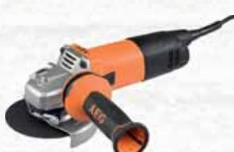
Ø disco 125 mm, n° 11500 giri/min., funzione Line lock out (LLO) per prevenire il riavvio automatico in caso di interruzione della corrente, testa degli ingranaggi ruotabile ad intervalli di 90° per una maggiore versatilità, blocco dell'alberino. Filettatura albero M14 In dotazione: impugnatura addizionale, flangia, dado per flangia e carter.
