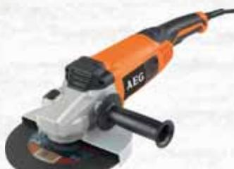
Ø disco 230 mm, n° 6600 giri/min., carter regolabile con chiave, blocco dell'alberino. Funzione Line Lock out contro il riavvio accidentale in caso di ripresa della corrente. Funzione Softstart. Accesso facilitato per la sostituzione dei carboncini. In dotazione: impugnatura addizionale, carter, flangia e chiave per flangia.
