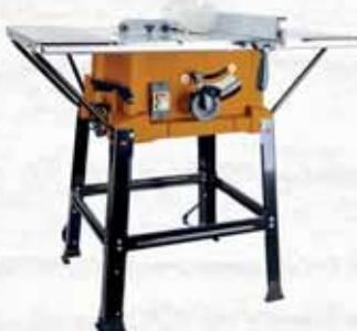
Ø lama 250 mm, Ø foro 30 mm, 4700 g/min., dimensioni del piano 638x430 mm, dispositivo di regolazione lama (altezza, inclinazione 0°-90°), guida parallela con morsetto eccentrico, protezione lama, banchetto d'appoggio stabile. Profondità di taglio max 55mm 45°, 80mm 90°. Potenza 1800 Watt. Tensione 230V/50Hz. Cavo 2mt.
