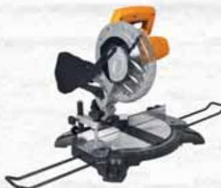
Ø lama 210 mm, Ø foro 30 mm, 5000 g/min., angolo di taglio 0-45°, profondità/larghezza di taglio 55x120 mm (55x83 mm a 45°), piano di lavoro in alluminio pressofuso. Potenza 1400 Watt. Tensione 230V/50Hz.
