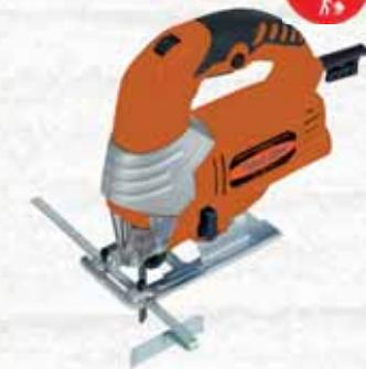
Potenza 650 Watt. Numero corse 0 - 3000/min. Profondità di taglio nel legno 65mm. Profondità di taglio nell'acciaio 6mm. Platorello inclinabile 0 - 45°. Attacco Black & Decker.
