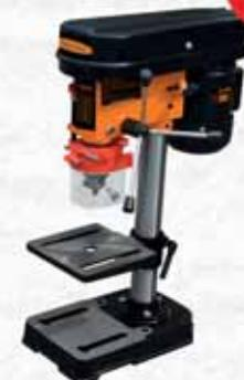
Regolazione velocità su 5 posizioni, da 600 a 2600 giri/min., mandrino a cremagliera fino a 13 mm, piano a forare in ghisa mm.314x200, altezza del piano regolabile. Totale altezza 580h. Potenza 350 Watt.
