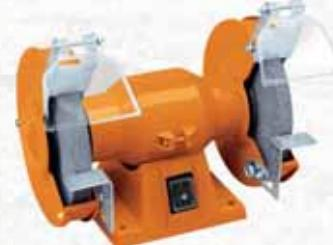
Dimensioni mole Ø 150x16 mm, nr:giri 2950/min. Protezione laterale delle mole di sicurezza. Potenza 150 Watt. Tensione 230V/50Hz.
