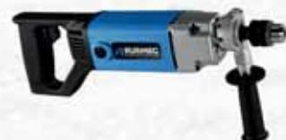
Miscelatore a frusta con l'impugnatura a trapano. Idoneo per miscelare intonaci, malte, stucchi, colle, resine, pitture, smalti e vernici. Interruttore elettronico. Blocco in ON. Attacco sia M14 che esagonale applicando il mandrino in dotazione. Monta mescolatori fino a 140 mm di diametro. Cavo 2 mt. In dotazione: Cassetta; impugnatura supplementare; raccordo 1/2"; mandrino; istruzioni.
