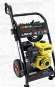
Motore 4 Tempi. Potenza 6,5HP. Pressione max: 200 bar. Portata max (l/h): 690. Giri motore (RPM): 3600. Gruppo pompa assiale, testata in ottone a tre pistoni in acciaio ad alta resistenza con valvola by-pass incorporata. Aspirazione detergente integrata con sonda aspirante esterna. Carrello portante in acciaio con manico ergonomico e vano porta accessori. Ideale per utilizzi laddove non è possibile collegarsi all'alimentazione elettrica. Peso: 37Kg. Dimensioni (CM): 47x47x97H.
