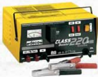
Con avviatore rapido. Adatto alla ricarica di batterie al piombo WET con e senza manutenzione, AGM. Regolazione della corrente di carica, protezione termostatica, protezione contro le inversioni di polarità, protezione contro i corto circuiti alle pinze, arresto manuale della carica. Alimentazione 1Phx230V, potenza 0,2-3 KW, corrente di carica media 13 Amp, corrente di avviamento 230 Amp, capacità batteria 20-300 Ah.
