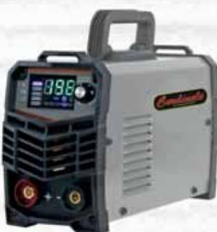
Consente di saldare in corrente continua elettrodi rutilici Ø 2,5-4,0 mm, alimentazione 1Phx230V, campo di regolazione 20-200Amp, duty cycle 60%. Protezione termostatica, protezione da sovratensioni: può essere collegata a generatori. In dotazione: accessori per saldatura.
