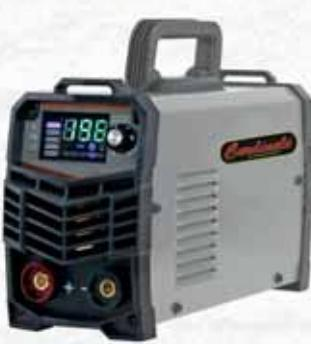
Consente di saldare in corrente continua elettrodi rutilici Ø 1,6-3,2 mm, alimentazione 1Phx230V, campo di regolazione 20-160Amp, duty cycle 60%. Protezione termostatica, protezione da sovratensioni: può essere collegata a generatori. In dotazione: accessori per saldatura.
