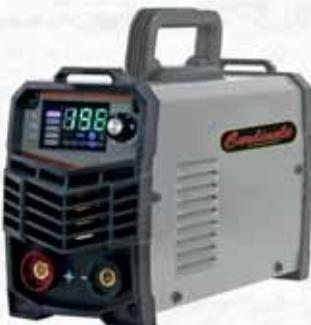
Consente di saldare in corrente continua elettrodi rutilici Ø 1,6-3,2 mm, alimentazione 1Phx230V, campo di regolazione 20-140Amp, duty cycle 60%. Protezione termostatica, protezione da sovratensioni: può essere collegata a generatori. In dotazione: accessori per saldatura.
