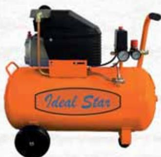
**25 (LT)** - Lubrificato ad olio di tipo coassiale. Motore monofase HP 2, aria aspirata 184 l/m, pressione max 8 bar n° di giri 2800. 1 attacco Peso 27kg. **50 (LT)** - Lubrificato ad olio di tipo coassiale. Motore monofase HP 2,0, aria aspirata 184 l/m, pressione max 8 bar n° di giri 2800. 1 attacco Peso 40kg
