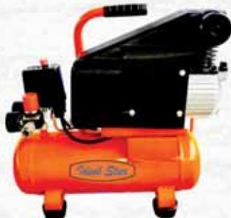
**6 (LT)** - Lubrificato ad olio di tipo coassiale. Motore monofase HP 1.0, aria aspirata 116 l/m, pressione max 8 bar n° di giri 2850. 1 attacco Peso 18kg.
