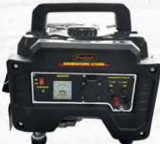
Generatore con prestazioni affidabili, di facile funzionamento e spostamento. Dotato di sistema di spegnimento automatico del sovraccarico AVR, uscita stabile, basso consumo di olio e rumorosita' (65dB). Motore 4 tempi a benzina. Potenza 2,9Hp. Avviamento a strappo. Potenza nominale: 900 Watt. Potenza massima 1000 Watt. Serbatoio da 6lt. Autonomia: 9h. Dimensione:460x370x380mm. Peso:26kg
