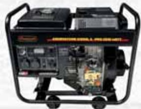
Generatore diesel 4,8/5.0kW. Tensione nominale: 220V/50HZ, monofase. Uscita CC: 12V/8,3 A. Dimensione: 730x470x700mm. Peso 120kg. Modello motore: LT186FA a iniezione diretta raffreddato ad aria. Sistema di avviamento: elettrico co batteria. Allarme olio basso. Sistema di interruzione automatica del sovraccarico AVR, uscita stabile. Basso consumo di olio, bassa rumorosità, compreso di ruote per facilitarne lo spostamento. Dotato di connettore per collegamento al quadro ATS (non incluso).
