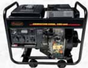
Generatore diesel 4,8/5.0kW. Tensione nominale: 220V/50HZ, monofase. Uscita CC: 12V/8,3 A. Dimensione: 730x470x700mm. Peso 120kg. Modello motore: LT186F a iniezione diretta raffreddato ad aria. Sistema di avviamento: elettrico co batteria. Allarme olio basso. Sistema di interruzione automatica del sovraccarico AVR, uscita stabile. Basso consumo di olio, bassa rumorosità, compreso di ruote per facilitarne lo spostamento.
