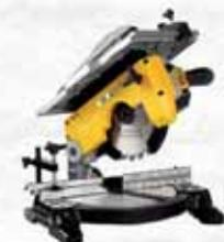
Motore monofase 1200 Watt, nr.giri 4200/min. Capacità di taglio: 120x50 mm a 0° e 120x35 mm a 45°, 60x60 mm a 45° sx - dx e 24x25 mm a composto 45°+45° mm. Ampia base di appoggio rettificata in alluminio rigido e solido, con facile e pratica regolazione dell'angolo di taglio. Nuova impugnatura e nuova alzata piano regolabile. In dotazione: morsetto verticale, spingilegno, chiavi di corredo e asta fermo barra. Peso 10Kg.
