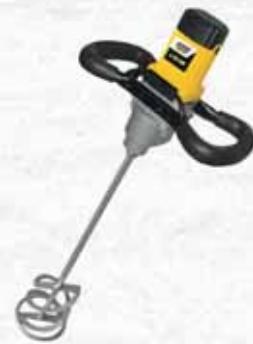
Potente motore monofase da 1400 Watt. Due velocità (Da 150 a 300 / da 300 a 650 giri/min.). Attacco frusta : M14. In dotazione 1 frusta tipo H2 - H 600 mm D.140 mm. Peso: 7 Kg. Alimentazione: 230V-50Hz.
