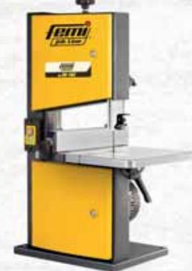
Motore monofase 250 Watt. Dimensioni del piano di lavoro: 300x300 mm. Taglio max 200 mm. Taglio max verticale 80 mm. Velocità lama (mt/min): 900. Dentatura Z/1": 6. Inclinazione del piano di lavoro: da 0° a 45°. Collo di cigno: 200 mm. Diametro bocchetta di aspirazione: 40 mm. In dotazione: Lama, Guida parallela, Spingilegno e chiavi di servizio. Alimentazione 230V-50Hz. Peso 15,5 Kg.
