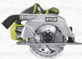
Lama di alta qualità 165mm TCT a 24 denti per una performance di taglio eccezionale. Alesaggio: 16 mm. Potente motore con velocità a vuoto di 4.700 giri/min per tagliare pannelli di legno, compensato e truciolare. Grande profondità di taglio: 52mm a 90°, 36mm a 45°. Beccuccio di espulsione polveri orientabile per convogliare i trucioli lontano dall'operatore. Batteria e caricabatteria non inclusi.
