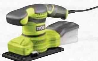
Ideale per applicazioni come la finitura e la rimozione di vernice. Potente motore 200W. Possibilità di fissare i fogli abrasivi con gancio o velcro. Tecnologia con azione ciclonica per la massima efficienza nella raccolta della polvere. Basse vibrazioni per un totale controllo. Diametro dell'orbita (mm) 2. Velocità a vuoto (giri/min) 12000. Dimensione foglio (mm) 93x185. In dotazione: 4 fogli abrasivi (2 x grana 60, 1 x grana 100, 1 x grana 150). Peso 2 Kg.
