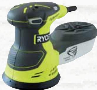
Potente motore 300 Watt. Movimento rotorbitale per una grande rimozione del materiale. Impugnatura compatta per elevato comfort. Azione ciclonica per la massima raccolta delle polveri. Indicatore di presenza tensione elettrica Livetool IndicatorT. Velocità regolabile. Velocità a vuoto (giri/min) 7,000-12,000. Diametro dell'orbita (mm) 2,4. Dimensione foglio (mm) 125. Peso 2 Kg.
