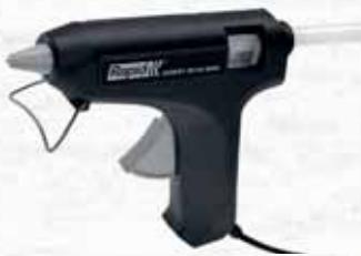
Massima estrusione colla/ora 150g/h. Ugello con protezione siliconica. Supporto regolabile per una posizione ottimale di incollaggio. Tempo di riscaldamento 15 min. Adatta per montaggi e riparazioni su legno, plastica, cartone, gomma e cuoio, posa e riparazione di piastrelle e porcellane. Per colle standard Ø 12mm. In dotazione 6 stick di colla trasparente.
