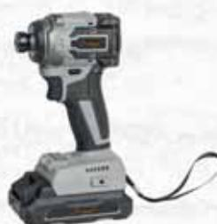
Avvitatore a impulsi brushless 20V. 4 regolazioni di Velocità a vuoto: 0-1200/0-1900/0-2500/0-3200 giri/min. Frequenza di impatto: 0-1400/0-1800/0-3500/0-4000 bpm. Coppia massima: 60/120/180/230 Nm. Attacco esagonale da 1/4". Funzione autofreno in senso antiorario. Impugnatura antiscivolo e luce led. Batteria e caricabatteria non inclusi. Peso: 980gr.
