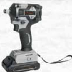
Avvitatore a impulsi brushless 20V. 2 regolazioni di Velocità a vuoto: 0-1600/0-2600 giri/min. Frequenza di impatto: 3000-3500 bpm. Coppia massima: 280/400 Nm. Attacco quadro da 1/2". Frizione elettronica e freno automatico. Impugnatura antiscivolo e luce led. Batteria e caricabatteria non inclusi. Peso: 1120gr.
