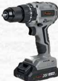
Trapano avvitatore a percussione a batteria 20V (Non inclusa). Motore brushless. Mandrino in metallo da 13mm. Coppia massima: 50 Nm. Velocità a vuoto: 0-400/0-1600 giri/min. Frequenza impatto: 0-6.000/0-24.000 percussioni min. Indicatore con luce a led e gancio per attaccarlo alla cintura. Batteria e caricabatteria non inclusi.
