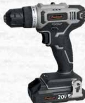
Trapano avvitatore a batteria 20 (Non inclusa). Mandrino autoserrante 10mm. Due velocità 0-350/0-1400 giri/min. Coppia max 32Nm. Luce led e funzione blocco del mandrino. Include: 2 inserti da 50 mm. Batteria e caricabatteria non inclusi.
