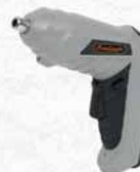
Batteria agli ioni di litio da 3,6 V CC-1300 mAh. Velocità a vuoto: 230 giri/min. Coppia massima: 5 Nm. Mandrino di uscita in acciaio da 1/4". Con linea di ricarica USB. Caricabatterie non incluso. In dotazione: 11 inserti da 25 mm e 1 porta inserti da 60 mm.
