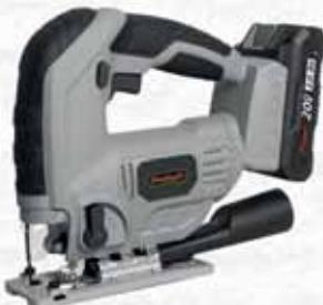
Seghetto alternativo a batteria 20V (Non inclusa). Velocità a vuoto: 0-3000 spm. Lunghezza corsa: 20 mm. Con luce LED. Con attacco lama a sgancio rapido. Capacità di taglio massima: 80 mm nel legno e 6mm in acciaio. Batteria e caricabatteria non inclusi.
