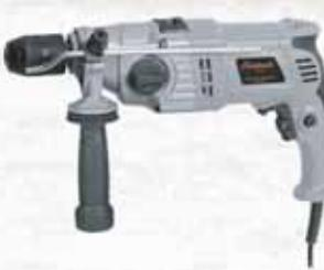
Tensione/Frequenza: 230 V/50 HZ. Mandrino autoserrante da 13 mm. Velocità a vuoto: 0-1100/3000 giri/min. Massimo di impatto: 17600/48000 bpm. Capacità di perforazione: acciaio: 13 mm/cemento: 20 mm/ legno: 30 mm. Accessori: 1 set di spazzole di carbone, 1 arresto di profondità, 1 impugnatura ausiliaria.
