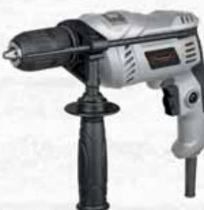
Tensione nominale: 220-240V/50-60Hz. Potenza nominale: 600W. Mandrino autoserrante 13mm. Giri min:0-3000. colpi min:48000. Capacità foratura: Ferro: Ø 13 mm, Legno: Ø 25 mm, Calcestruzzo: Ø 13 mm. Impugnatura supplementare.
