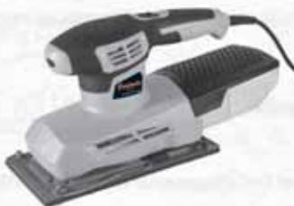
Tensione/Frequenza: 230V/50Hz. Potenza in ingresso: 300 Watt. Velocità a vuoto: 6000-12000 opm. Dimensioni del cuscinetto: 230 \* 115 mm. Base in alluminio Morsetto a strappo. Accessori: scatola per la polvere da 1 pz; carta abrasiva da 1 pz.
