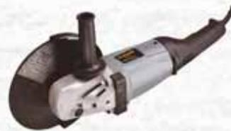
Tensione: 230 V/50 HZ. Potenza: 2350 W. Velocità a vuoto: 6500 giri/min. Diametro: 230 mm. Filettatura del mandrino della smerigliatrice: M14. Impugnatura posteriore rotante Confezione: scatola dei colori Accessori: 1 set di spazzole in carbone, 1 chiave inglese, 1 protezione di protezione, 1 impugnatura ausiliaria.
