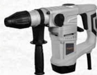
Tensione/Frequenza: 230 V/50 HZ. Potenza in ingresso: 1500 W. Attacco: SDS-plus. Velocità a vuoto: 900 giri/min. Potenza colpo: 4300 bpm Joule di impatto: 5,5 J. Capacità di perforazione: acciaio: 13 mm/cemento: 32 mm/legno: 42 mm. Accessori: Valigetta, 1 set di spazzole di carbone, 1 arresto di profondità, 1 impugnatura ausiliaria, 2 scalpelli SDS e 3 punte per trapano, 1 scatola di grasso, 1 chiave inglese, 1 arresto di profondità, 1 protezione antipolvere.
