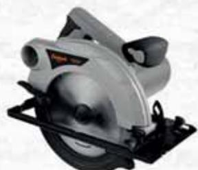
Motore da 1200 Watt. Lama di 180mm TCT a 24 denti. Velocità a vuoto 5000(giri/min). Capacità di taglio di 63mm a 90°, 43mm a 45°. In dotazione: 1 lama, guida parallela e una chiave.
