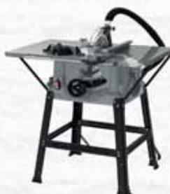
Tensione: 230 V/50 HZ Potenza in ingresso: 1800 W. Velocità a vuoto: 5000 giri/min. Dimensioni disco: 250 mm x 24 denti, foro 30mm. Campo di taglio: 0-45°. Altezza di taglio: 90° max 85mm - 45° max 65mm. Altezza operativa: 829 mm. Cavo di alimentazione da 2 m. Porta polvere: 35 mm. Con supporto, tavolo principale in acciaio con due tavoli allungabili
