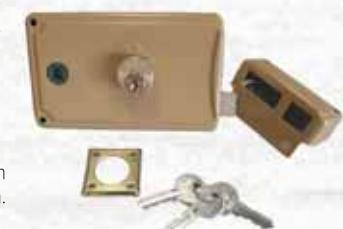
Doppio cilindro: cilindro interno fisso a 3 pistoncini e cilindro esterno a 5 pistoncini (2 antimanipolazione). Verniciate elettrostaticamente con polvere epossidica colore nocciola. Scrocco e catenaccio a 3 mandate. Quadro maniglia mm 8. Cilindro esterno fisso con sporgenza 50 mm. In dotazione: 3 chiavi in ottone nichelato, bocchetta, borchia e viti di fissaggio.
