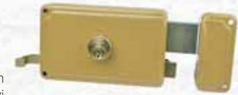
Doppio cilindro: cilindro interno fisso a 3 pistoncini e cilindro esterno a 5 pistoncini (2 antimanipolazione). Verniciate elettrostaticamente con polvere epossidica colore nocciola. Scrocco e catenaccio a 3 mandate. Cilindro esterno fisso con sporgenza 50 mm. In dotazione: 3 chiavi in ottone nichelato, bocchetta, borchia e viti di fissaggio.
