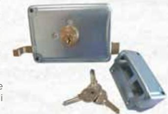
Doppio cilindro: cilindro interno fisso a 3 pistoncini e cilindro esterno a 5 pistoncini (2 antimanipolazione). In acciaio zincato. Scrocco e catenaccio a 2 mandate. Cilindro esterno fisso con sporgenza 50 mm. In dotazione: 3 chiavi in ottone nichelato, bocchetta, borchia e viti di fissaggio
