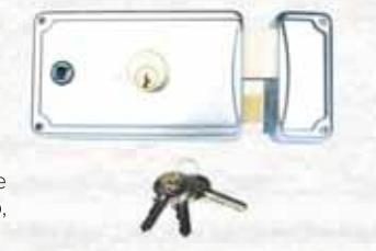
Doppio cilindro: cilindro interno fisso a 3 pistoncini e cilindro esterno a 5 pistoncini (2 antimanipolazione). In acciaio zincato. Scrocco e catenaccio a 3 mandate. Quadro maniglia mm 8. Cilindro esterno fisso con sporgenza 50 mm. In dotazione: 3 chiavi in ottone nichelato, bocchetta, borchia e viti di fissaggio.
