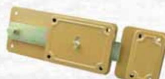
Pomolo interno. Cilindro esterno fisso a 5 pistoncini (2 antimanipolazione). Verniciate elettrostaticamente con polvere epossidica colore nocciola. Catenaccio con chiusura a 5 mandate con scrocco incorporato. Cilindro esterno fisso con sporgenza 50 mm. Dimensione scatola 209x90 mm. Dimensione bocchetta 75x90 mm. Dotazione: 3 chiavi in ottone nichelato, bocchetta, borchia e viti di fissaggio.
