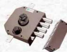
Quintuplice con mezzo giro. 4 Mandate, corsa chiavistelli Ø 40 mm. Corsa aste mm. 17. Interasse mm. 25. Dimensione scatola mm 132x146. In dotazione 3 chiavi.
