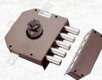
Quintuplice senza mezzo giro. 4 Mandate, corsa chiavistelli Ø 40 mm. Corsa aste mm. 17. Interasse mm. 25. Dimensione scatola mm 132x146. In dotazione 3 chiavi.
