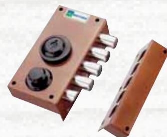
Laterale con mezzo giro, apertura interna con chiave, pompa-cilindro Ø 30 esterna lunghezza mm.60, corsa chiavistelli mm.24. Scatola verniciata bronzo mm.80x152x30.
