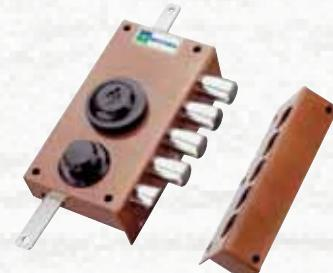
Triplice con mezzo giro, apertura interna con chiave, pompa-cilindro Ø 30 esterna lunghezza mm.60, corsa chiavistelli mm.24, corsa aste mm.16. Scatola verniciata bronzo mm.80x152x30.
