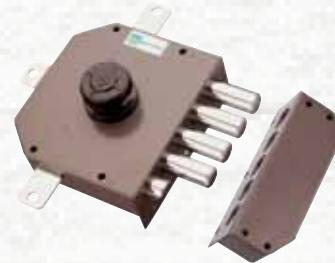
Quintuplice con mezzo giro, apertura interna con pomolo, pompa-cilindro Ø 30 esterna lunghezza mm.60, corsa chiavistelli mm.40, corsa aste mm.17. Scatola verniciata mm.132x146x30.
