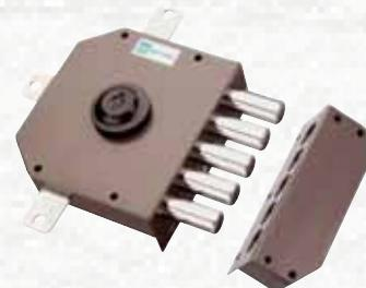
Quintuplice senza mezzo giro. 4 mandate, pompa cilindro Ø 34 lunghezza mm. 60. Corsa chiavistella mm. 40. Corsa aste mm. 17. Dimensione scatola mm. 132x146. In dotazione 3 chiavi.
