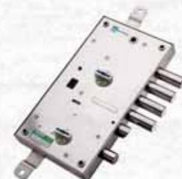
Triplice con mezzo giro. Serratura superiore triplice 4 mandate con corsa mm. 40, interasse mm.28. Serratura inferiore 2 mandate con corsa mm. 18, interasse mm. 22. Corsa aste mm 20. Completo di guida chiave interna mm. 15 ed esterna mm. 28. Scatola mm 136x254. In dotazione 3+3 chiavi (Gambo 60 mm).
