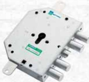
Triplice con mezzo giro reversibile, azionato da chiave e quadro maniglia mm.8. N. 4 chiavistelli tondi Ø 19 con corsa mm.29, corsa aste mm.14. Scatola mm.132x165x35.
