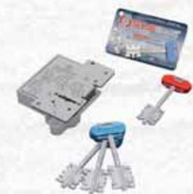
Cuore Easy Master a doppia mappa. 4 Mandate. Corsa mm 30. 6 leve. In dotazione: 1 chiave di cantiere, 3 chiavi definitive. Dimensioni: 69,4x91,5 mm
