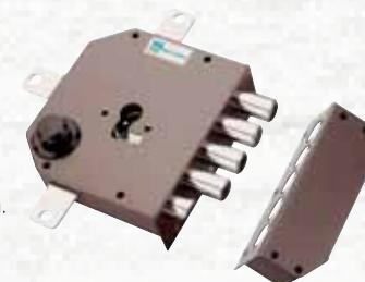
Serratura quintuplice da applicare con mezzo giro. Corsa chiavistelli mm. 29. Corsa aste mm. 17. Interasse mm. 25. Dimensione scatola mm. 132x146.
