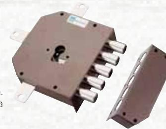
Serratura quintuplice da applicare con aste (non in dotazione) con scrocco con predisposizione per cilindro europeo. Corsa chiavistelli mm. 29. Corsa aste mm. 17. Apertura esterna con chiave ed interna con chiave o pomolo in funzione del cilindro applicato. Dimensione scatola mm. 132x146. In dotazione 3 chiavi.
