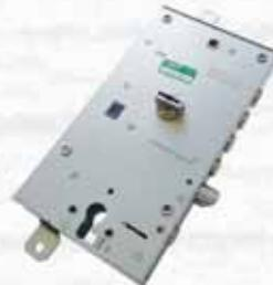
Triple con mezzo giro a doppia mappa e cilindro. Serratura superiore triplice 4 mandate con corsa mm. 40, interasse mm. 28 . Serratura inferiore 2 mandate con corsa mm. 18, interasse mm. 22. Corsa aste mm 20. Completo di guida chiave interna mm. 15 ed esterna mm. 28. Scatola mm 136x254. In dotazione 3 chiavi (Gambo 60 mm).
