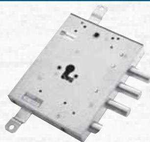
Triplice con mezzo giro reversibile Ø 20 mm azionato da cilindro e maniglia. Fissaggio serratura tramite n°4 attacchi laterali. Chiavistelli Ø 18 corsa 29 mm. Corsa aste 20 mm. Interasse 37 mm. Fissaggio cilindro con 'Attacco' Mottura. Fori fissaggio Ø 8,1 mm (Ø 6 mm con riduttore). Defender Scatola mm 185x305.
