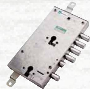
Serratura doppia con mezzo giro per cilindro. Serratura superiore triplice con n. 4 chiavistelli tondi Ø 18 con corsa mm 29 e corsa aste mm. 20. Serratura inferiore laterale con 1 chiavistello tondo Ø 18 con corsa mm. 22. Dimensione scatola mm. 136x254.
