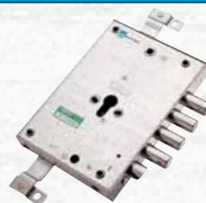
Triplice con mezzo giro reversibile Ø 20 mm azionato da cilindro e maniglia. Doppio sistema anti-intrusione. Chiavistelli Ø 18 corsa 29 mm. Corsa aste 20 mm. Sbalzi aste 24 mm. Interasse 28 mm. Fissaggio cilindro con vite di testa. Scatola mm 146x206.
