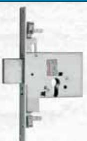
Serratura a cilindro sagomato ad altissima sicurezza per serramenti e cancelli. Chiusura tramite catenaccio a 3 mandate con corsa da mm 30. Chiusura triplice boccole filettate M8 per fissaggio aste. Corsa mm 20. Frontale in acciaio zincato con bordo quadro da mm 25x240.
