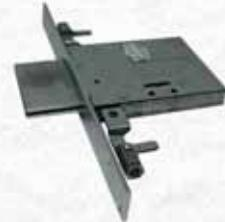
Serratura a doppia mappa ad altissima sicurezza per serramenti e cancelli. 4 Mandate. Triplice chiusura. Chiusura tramite catenaccio con corsa mm 40 e boccole filettate M8 (Aste non in dotazione). Frontale in acciaio zincato con bordo quadro mm 25x240. In dotazione: 1 piastrina, 2 chiavi.
