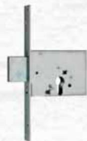
Serratura a cilindro sagomato ad altissima sicurezza per serramenti e cancelli. Chiusura tramite catenaccio a 3 mandate con corsa da mm 30. Frontale in acciaio zincato con bordo quadro da mm 25x240.
