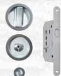
Kit composto da: serratura a gancio solo quadro E50, nicchia Ø mm.48 con nottolino, nicchia Ø mm.48 con vite di emergenza e trascinatore Ø mm.25.
