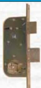
**2** Mandata da 10 mm. Scatola e frontale zincati tropicalizzato. Funzionante con cilindro Ø 26 mm sfaccettato. Catenaccio e scrocco separato. Richiamo scrocco con quadro maniglia 8 mm. Cilindro in dotazione con 3 chiavi.
