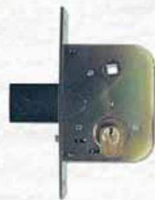
**1** Mandata da 10 mm. Scatola e frontale zincati tropicalizzato. Funzionante con cilindro Ø 26 mm sfaccettato. Catenaccio prolungato e scrocco incorporato. Richiamo scrocco con chiave o pomolo interno. Cilindro in dotazione con 3 chiavi. 2 ghiere in nylon per cilindro in dotazione.
