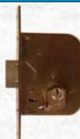
**2** Mandata da 10 mm. Scatola e frontale zincati tropicalizzato. Funzionante con cilindro Ø 26 mm sfaccettato. Cilindro in dotazione con 3 chiavi. 2 ghiere in nylon per cilindro in dotazione.
