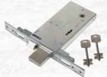
Da fascia a 3 punti di chiusura, scrocco e catenaccio a 4 mandate. Reversibile. Asole per il montaggio facilitato delle aste interne completo di 2 attacchi M8. Frontale e coprifrontale in acciaio inox da mm.28.
