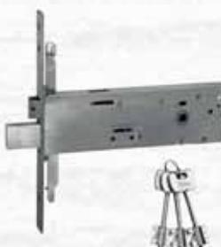
**4** Mandate da 9 mm. Serratura ad infilare modulare. Chiusura triplice. Agganci asta a vite. Frontale inox 240x22x3 mm. Altezza cassa 64 mm. Scrocco separato reversibile e regolabile. Possibilità di sostituire lo scrocco con il rullo o con il tappo per chiusura solo catenaccio. In dotazione: 3 chiavi, 2 guida chiave in nylon, coppia spessori sottofrontale, grano interno per fissaggio cilindro e viti fissaggio.
