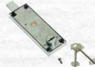
Serratura per porte basculanti con cilindro fisso a doppia mappa da mm 25. Sbloccaggio con chiave e apertura con maniglia sia dall'interno che dall'esterno. Corsa catenaccio mm 25. Quadro maniglia mm 8. Interasse mm 67. Scatola in acciaio zincato mm 56x156. Spessore mm 16. In dotazione: 2 chiavi doppia mappa.
