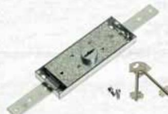
Serratura per serranda con cilindro fisso a doppia mappa da mm 25. Movimentazione con chiave sia dall'interno che dall'esterno. Corsa catenaccio mm 20. Scatola in acciaio zincato mm 156x56. Spessore mm 16. In dotazione: 3 chiavi a doppia mappa.
