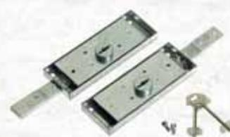
Serratura per serranda con cilindro fisso a doppia mappa da mm 25. Movimentazione con chiave sia dall'interno che dall'esterno. Corsa catenaccio mm 20. Scatola in acciaio zincato mm 156x56. Spessore mm 16. In dotazione: 3 chiavi a doppia mappa.
