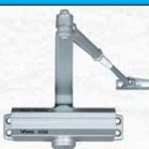
Monoblocco in alluminio presso-fuso verniciato. Braccio con lunghezza regolabile. Valvole di regolazione della velocità di chiusura e della velocità del colpo finale. Forza di chiusura: multiorza. Applicabile su porte con lungh. cm.85-110 e peso kg 45-85. Finitura colore grigio.
