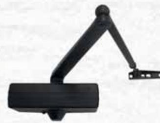
Unico corpo in ghisa, custodia di finitura in ABS. Forza di chiusura variabile EN 2-5. Fermaporta integrato di facile e precisa regolazione. velocità di chiusura regolabile tra 180° e 0°. Colpo finale regolabile tra 15° e 0° tramite tenditore del braccio. Applicabile su porte con lungh. cm.85-125. Finitura colore nero.
