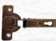
In acciaio. Senza molla. Apertura 110°. Applicazione standard. Profondità della scatolina metallica 11 mm. Diametro della scatolina: 35 mm. Possibilità di foratura dell'anta 'K' da 3 a 6 mm. Fornita senza basetta.
