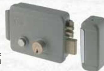
Scrocco azionato dall'esterno mediante chiave e dall'interno mediante pulsante, bloccabile con chiave, e a distanza mediante impulso elettrico a basso voltaggio: 12V. Catenaccio meccanico a 2 mandate azionato mediante chiave dall'interno e dall'esterno. Cilindro interno ed esterno fisso. Fornita di controbocchetta. Scatola mm.130x106.
