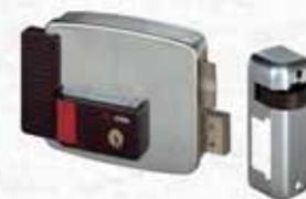
Scatola e bocchetta in acciaio verniciate grigio alluminio. Scrocco autobloccante. Tensione 12V. Corrente assorbita 2,5A. Catenaccio a mandate manuali. Pulsante e cilindro interno. In dotazione: Bocchetta e sottobocchetta. Viti di fissaggio. 3 Chiavi in dotazione. A norma Europea EN 14846:08. Grado 3 Security (500 Kg. alla spinta laterale e 200 Kg. alla spinta frontale).
