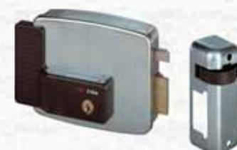
Scatola e bocchetta in acciaio con rivestimento in zinco. Scrocco autobloccante. Tensione 12V. Corrente assorbita 2,5A. Lunghezza cilindro esterno 55mm. In dotazione: Bocchetta e sottobocchetta. Tettuccio protettivo. Viti di fissaggio. 3 Chiavi in dotazione. A norma Europea EN 14846:08. Grado 3 Security (500 Kg. alla spinta laterale e 200 Kg. alla spinta frontale).
