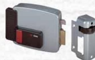
Scatola e bocchetta in acciaio verniciate grigio alluminio. Scrocco autobloccante. Tensione 12V. Corrente assorbita 2,5A. In dotazione: Bocchetta e sottobocchetta. Viti di fissaggio. 3 Chiavi in dotazione. A norma Europea EN 14846:08. Grado 3 Security (500 Kg. alla spinta laterale e 200 Kg. alla spinta frontale).
