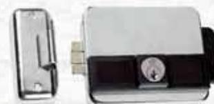
Reversibile. Entrata regolabile da 50 a 70 mm. Incontro regolabile in altezza, interassi dei fori di fissaggio unificati. Scrocco autobloccante. Cassa in acciaio. Alimentazione 8 - 12 VAC. Cilindro nichelato. 3 chiavi, 1 bocchetta, viti di fissaggio.
