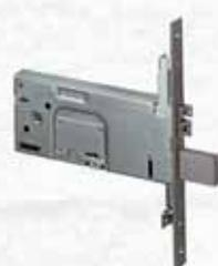
Scatola con rivestimento in zinco. Frontale in acciaio inox. Catenaccio in acciaio nichelato. Scrocco e pistone regolabile da 12 a 18 mm. Scrocco autobloccante e reversibile. Fermo a giorno. Predisposizione per chiusure supplementari con perni filettati. Intercambiabilità fra la versione elettrica e quella meccanica. Tensione 12V ca CE. Corrente assorbita 1,7A. Interasse mm 67. Frontale mm 22. 4 Mandate. In dotazione 3 chiavi, coppia borchie in nylon, viti di fissaggio.
