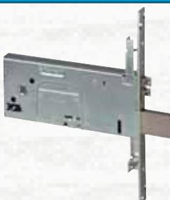
**4** Mandate. Scatola e frontale con rivestimento in zinco. Catenaccio e borchia in acciaio. Piastra di protezione antiscasso. Scrocco o scrocco/pistone reversibili nichelati. Intercambiabilità fra la versione elettrica e quella meccanica. Tensione 12V ca CE. Corrente assorbita 1,7A. Larghezza frontale 25 mm. Interasse 67 mm. 2 Chiavi in dotazione.
